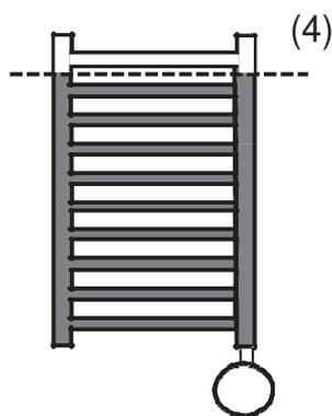
Accessorio: Per il funzionamento misto, con il controllo Smart, montare l'accessorio a “T” nel ritorno dello scaldasalviette, successivamente introdurre nel collettore verticale dell'accessorio a “T” lo smart, e collegare il ritorno del circuito di riscaldamento al collegamento a squadra dell'accessorio a “T”.
